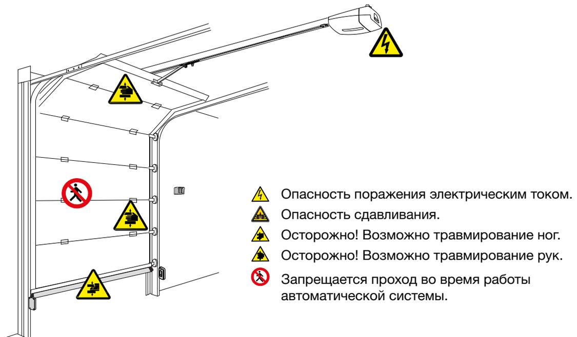
Если проезд предназначен только для транспортных средств, то для пешеходов должен быть организован отдельный вход. Если для проезда подается команда, то оператор (пользователь) всегда должен убедиться в том, что во время движения полотна ворот (открывания/закрывания) вблизи движущихся частей и деталей не находятся люди. Убедитесь в том, что движению ворот не препятствуют какие-либо неподвижные объекты, и следите за тем, чтобы территория вокруг ворот была свободной от помех.
