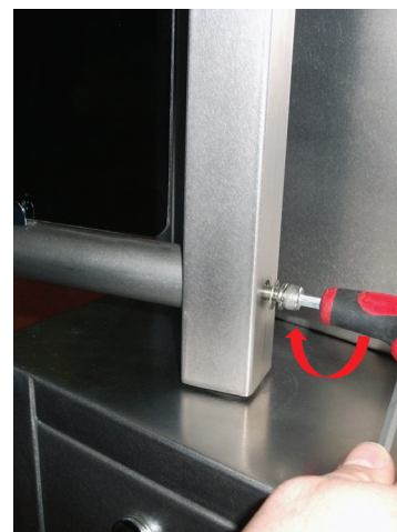
3. Затяните нижний винт
