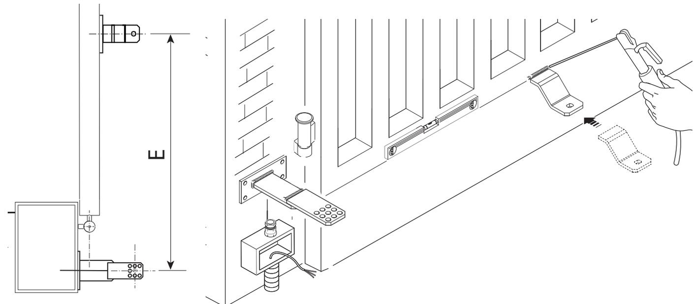
Закрепите привод на кронштейнах с помощью прилагаемых болтов и шайб.
