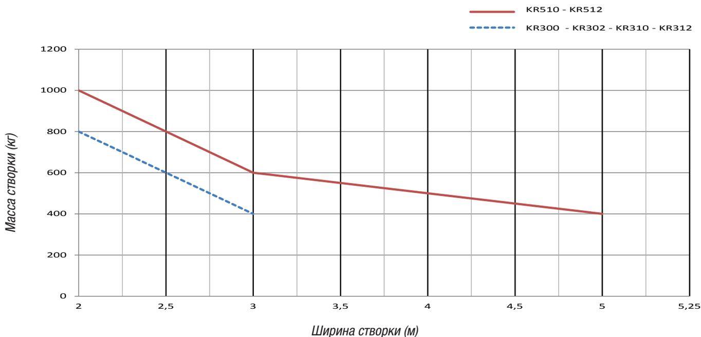
⚠️ На распашных воротах настоятельно рекомендуется устанавливать электрозамки для обеспечения надежного закрытия створок. Если используется самоблокирующийся привод, монтаж электрозамка является обязательным для створок шириной более 2,5 м.
