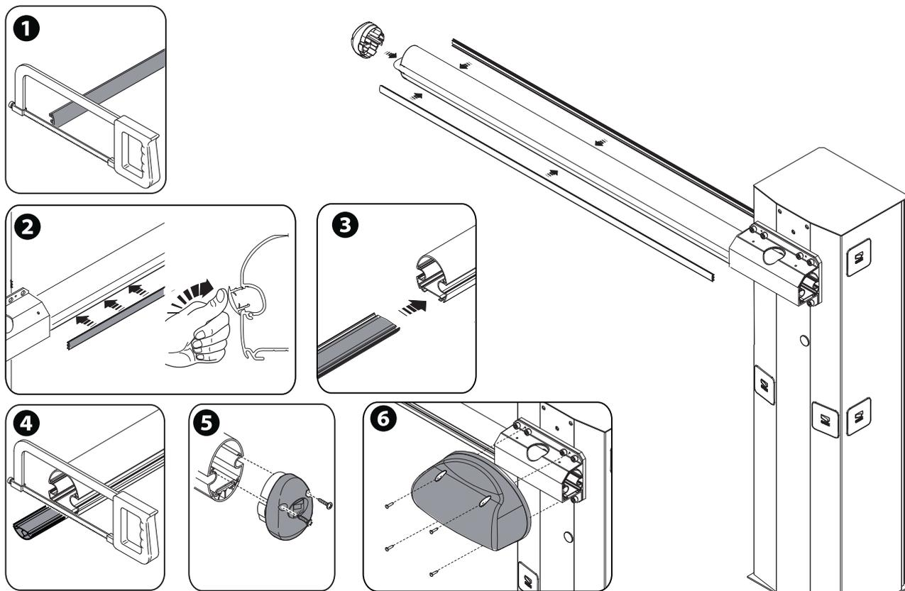
Примечание: для монтажа со стрелой 001G0402 вставьте и закрепите две уплотнительные прокладки (в комплекте со стрелой) в крепление стрелы так, как показано на рисунке.
