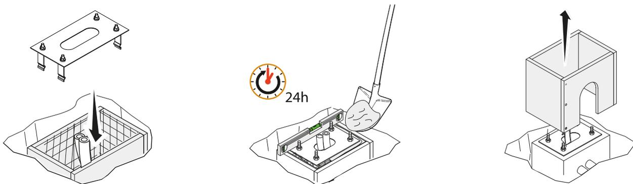
Засыпьте пространство вокруг цементного блока землей. Отвинтите гайки и снимите их с винтов.
